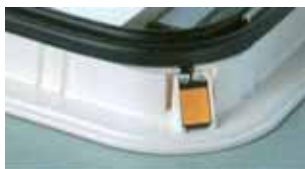
Heki 4plus è provvisto di sensore di pioggia.
